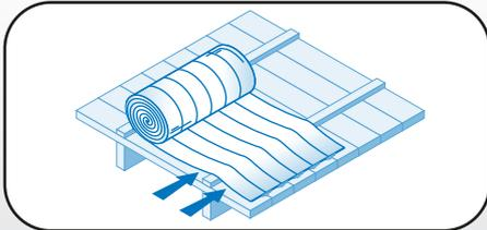
A. Desenrollá Super TBA con el aluminio "mirando hacia arriba", sobre listones de ventilación yeseros, cubriendo la superficie del machimbrado.
