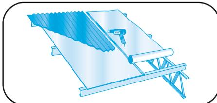
B. Colocar el segundo rollo termo soldando las uniones para lograr un techo impermeable y evitar la condensación por filtraciones de aire. Fijar los rollos con los mismos auto perforantes de la chapa.
