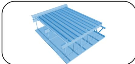
C. Continuar con el proceso y terminar con la colocación de un cielorraso suspendido interno. Recordá que nuestras espumas no pueden quedar expuestas a la reflexión indirecta de rayos UV.
