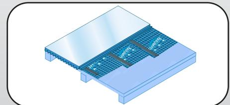
B. Sobre perfiles omega fijados cada 80cm, presentá Super TBA con el aluminio mirando "hacia arriba". No te olvides de termo solar las uniones.
