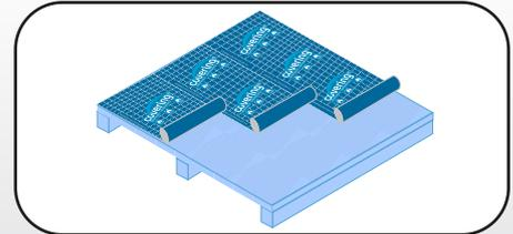
A. Sobre el OSB o multilaminado fenólico fijar con grampas o clavos la membrana impermeable respirable Covering.
