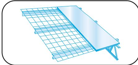
A. Colocá el aislante en el mismo sentido que las chapas, con el aluminio mirando "hacia arriba" sobre una malla de sostén o tensado de alambre.
