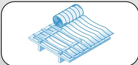
B. Fijá la membrana con listones yeseros nuevamente. No te olvides de termo soldar las uniones para lograr techos impermeables.
