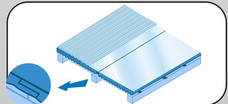
C. Fija la chapa junto con Super TBA con auto perforantes. Podés termo soldar varios rollos en el piso y subirlos para ahorrar tiempos de colocación y mano de obra.
