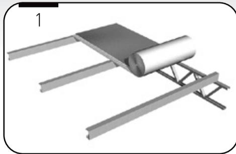
Sobre las correas estructurales presentar el rollo en el mismo sentido que las chapas de la cubierta. **¡No hace falta colocar una malla de sostén o tramado de alambre!**
