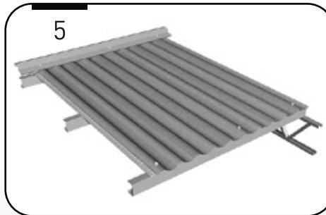
A partir de aquí se continúa con el ciclo realizando la unión por termosoldado de los rollos sobre la estructura y colocando las chapas de cubierta, sujetándolas con autoperforantes instalados en la cresta de la onda de la chapa.
