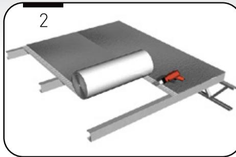
Colocá el segundo rollo paralelo al primero superponiendo los solapes para hacer la unión por termosoldado sobre la estructura. Recomendamos termosoldar en el piso varios tramos de aislante para agilizar y simplificar los trabajos en altura.
