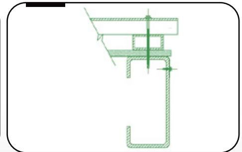
Es obligatorio para el uso de chapa U 45, T 101 o chapa plana similar, en Zonas Bioclimáticas I, II y III (Argentina) y países Sub Tropicales y Tropicales, el uso de perfil rectangular de 25x50 mm o un listón de madera de 2" x 1" para garantizar la vida útil del material.
