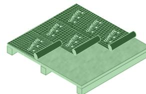
Sobre el OSB o multilaminado fenólico fijar con grampas o clavos la membrana impermeable respirable **Covering**.
