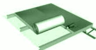
Colocar el segundo rollo termo soldando las uniones para lograr un techo impermeable y evitar la condensación por filtraciones de aire.
