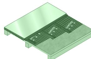
Sobre perfiles omega fijados cada 80cm, presentá **Súper TBA** con el aluminio mirando "hacia arriba". No te olvides de termo soldar las uniones.
