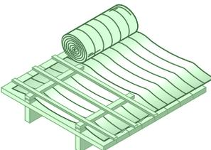
Continuá con el segundo rollo, solapando de abajo hacia arriba y termo soldando las uniones para asegurarte un techo completamente impermeable. Fijá los rollos con listones yeseros nuevamente.
