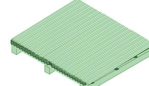
Completá la instalación fijando tanto chapa como **Super TBA** con auto perforantes.
