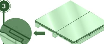
Podés colocar el aislante en cualquier orientación, siempre y cuando no te olvides de termo soldar las uniones. Podés termo soldar varios rollos en el piso y subirlos para ahorrar tiempos de colocación y mano de obra.
