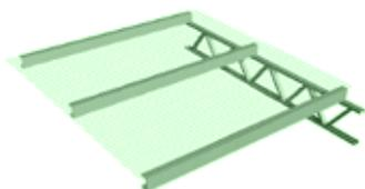
Sobre las correas se prepara un sostén de **RED 2x2 ISOLANT**. También puede utilizarse alambre galvanizado haciendo un entramado romboidal de 30x30 cm.
