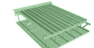
Fijar los rollos con los mismos auto perforantes de la chapa y terminar con la colocación de un cielorraso suspendido interno. Recordá que nuestras espumas no pueden quedar expuestas a la reflexión indirecta de rayos UV.
